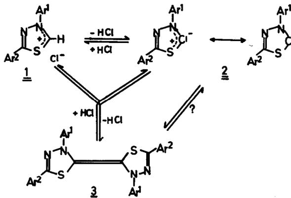
Die leichte Protolyse von 1 lässt auf eine Stabilisierung von 2 schließen. Es ergab sich die Frage, ob auch zwischen 2 und 3 ein Gleichgewicht existiert. Um dies zu prüfen, wurden Kreuzungsexperimente mit verschiedenen substituierten Dimeren 3 unter Ausschluss von Elektrophilen wie 1, HCl o.Ä. durchgeführt.
